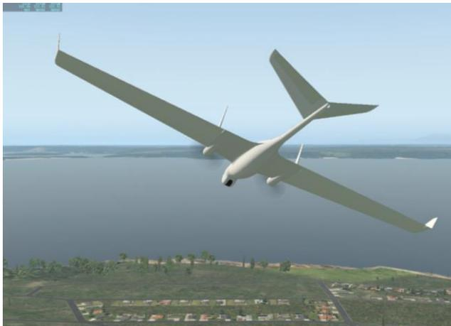
Тренажер совместно со стендом входят в состав аппаратно-программного комплекса HSS-UAV-2021, который может использоваться на всех стадиях разработки БЛА (от концептуального дизайна до серийного производства), в единой системе проводить полунатурное моделирование полета БЛА (курс, крен и тангаж) и работы всех его основных модулей и подсистем, включая работу программного обеспечения автопилота
