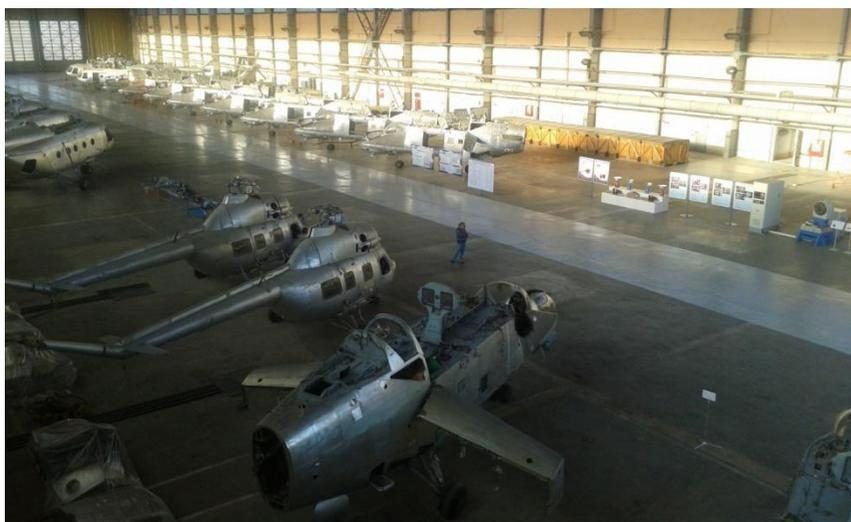
**Ангар № 2-** позволяет ремонтировать воздушные суда классом ТУ-134 и вертолеты всех типов. Полезная площадь 12.800 м<sup>2</sup> (производственная площадь-7200 м<sup>2</sup>, размеры 150x48,5x 11,5 м).
